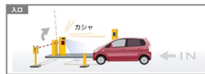
機械式ゲートの設置による不適正利用対策の事例
